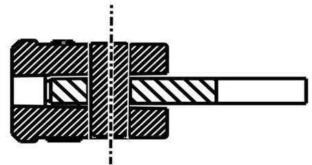
Bild zeigt korrekt eingepressten PIN,
