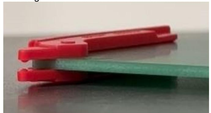
**Unkorrekter Einpressprozess, Incorrect press-in process,
